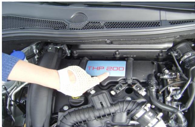
La puissance doit s'apprécier au regard de la masse de la voiture, ici 200 ch pour 1 160 kg, soit un rapport poids/puissance égal à 5,8 kg/ch ; pour bénéficier d'un rapport aussi favorable, une voiture de masse 1 800 kg devrait être équipée d'un moteur de 310 ch...
